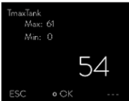
Fig. 34: Enter Tmax (here TmaxTank)
